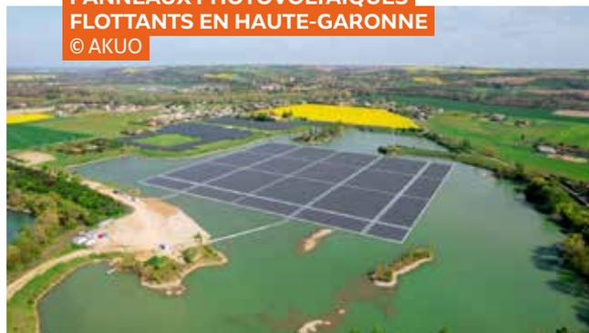
Nous pouvons citer le projet du lac de Saint-Savin et du plan d'eau artificiel du Cheylas. Ce type de milieu est « ciblé » par les développeurs aériens car la proximité de l'eau, agissant comme un climatiseur naturel, permet d'augmenter le rendement des panneaux solaires et donc la production électrique.
