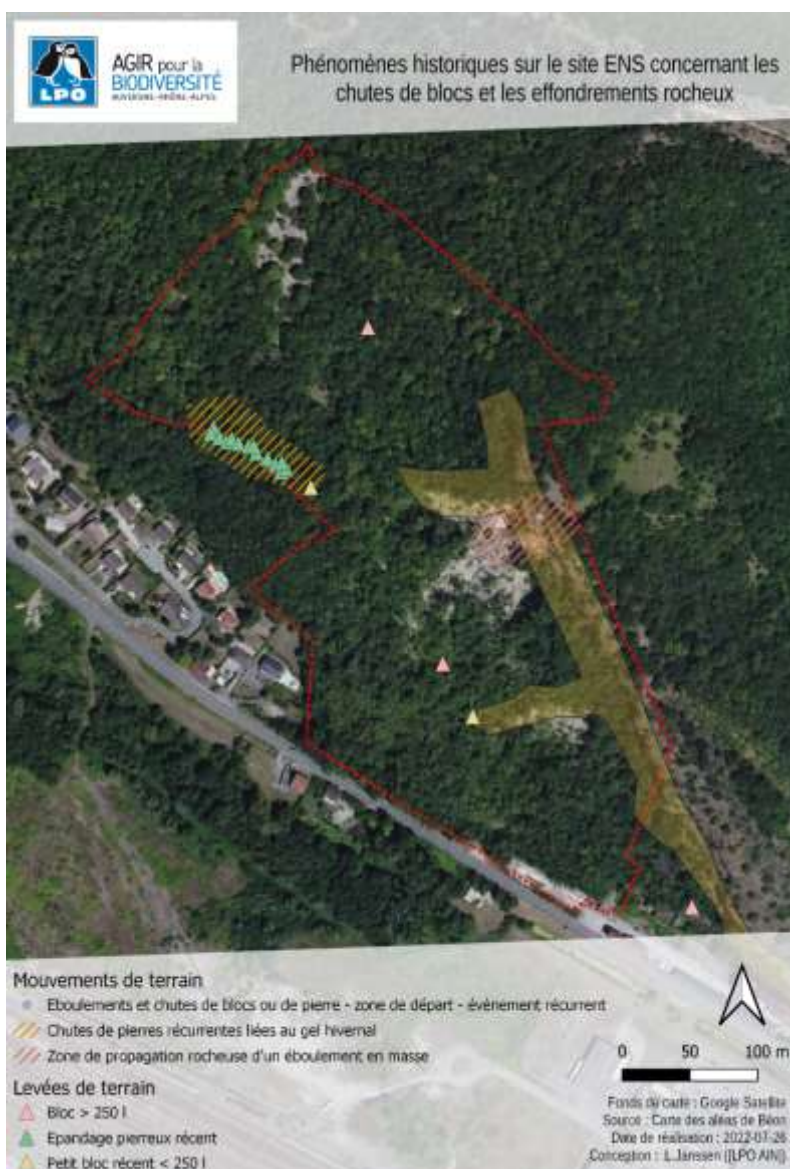
Figure 5 : Phénomènes historiques sur la commune de Béon concernant les chutes de blocs et les effondrements rocheux. Adapté de la carte des aléas de Béon
